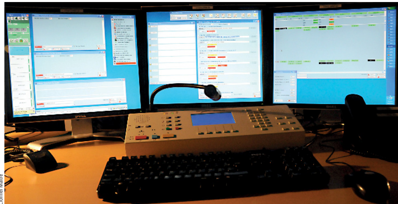
Le CTA-Codis du Sdis 69 est équipé du logiciel Artemis V2. Sur l'écran de gauche, on trouve des synoptiques par natures d'intervention (feu, avec moyen de commandement, problèmes de départ). Au milieu, le synoptique des interventions en cours, une fenêtre dédiée aux appels téléphoniques et une autre réservée au chef de salle pour les appels prioritaires. À droite, le synoptique des moyens.
